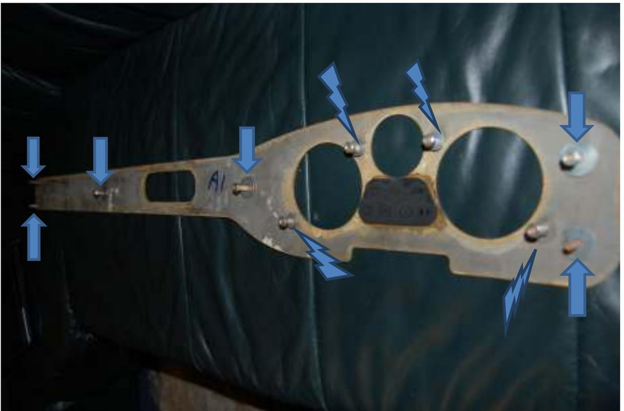
10. nun wird, wie auf dem 1. Foto zu Punkt 9 ersichtlich, das „Holzteil“ mit der Tacho-RPM-Uhr-Einheit vorgezogen und geklappt (Achtung, nicht zuviel Zug auf die Heizungsregler), so dass nun der Heizungsregler vom Bowdenzug getrennt werden kann
