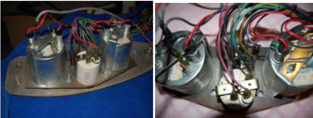
12. Jetzt wird das Armaturenbrett herausgenommen. Um Beschädigungen an den Türverkleidungen und am Armaturenbrett zu vermeiden, am besten Decken über die Türen und den Schalthebelbereich sowie auch über die Lenksäule legen. Lenksäule nicht zu stark nach unten belasten oder drücken. Beim Vorziehen des gesamten Armaturenbrettes die Tachoeinheit durch den Ausschnitt im Armaturenbrett wieder zurückziehen.
