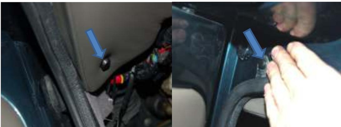
3. Lösen der Schrauben, die das Armaturenbrett mit dem Frontscheibenrahmen verbinden Die Schrauben lassen sich am besten durch die Position in Bezug auf das Scheibenwischergestänge finden (siehe Fotos links und rechts)
